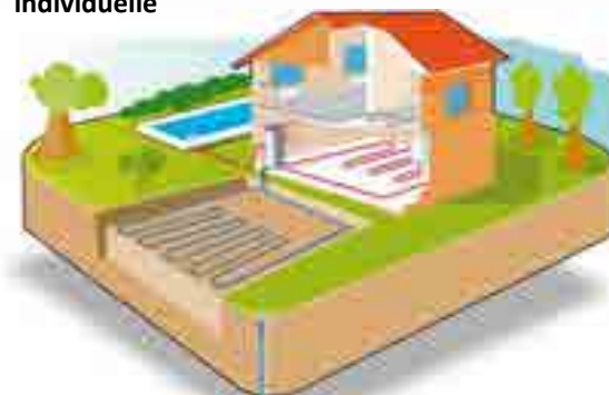
Installation géothermique sur une maison individuelle
