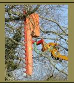
Le sécateur s'adapte sur l'épareuse. Deux scies longitudinales oscillent l'une contre l'autre (mouvement de va et vient). La longueur moyenne est de 2 mètres.
