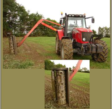
Le groupe de fauchage est un outil à axe horizontal. Il travaille en général sur 1,20 m. Le rotor est équipé de fléaux ou de marteaux. Il est conseillé d'utiliser les marteaux pour effectuer un premier travail grossier et d'opter pour les fléaux pour effectuer un travail d'entretien. La vitesse de rotation importante du rotor et des fléaux (2 800 tours/min environ) provoque un broyage du végétal et non une coupe.
